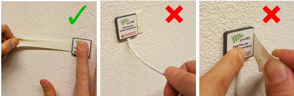
Abbildung 2: Korrektes Ablösen der Sensoren
