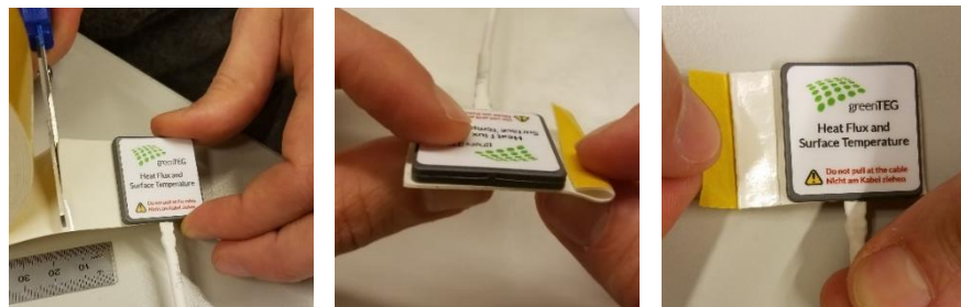
Abbildung 1: Korrekte Anbringung des Klebebands
