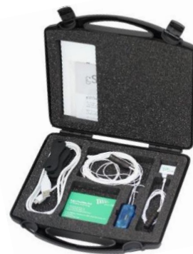
Abbildung 1: U-Wert Kit in Transportkoffer
